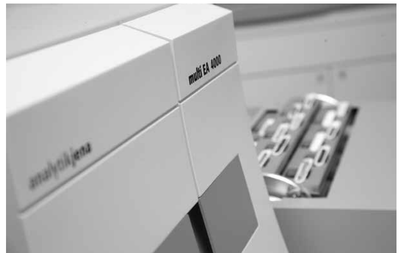
Fig. 2 : multi EA® 4000 avec distributeur d'échantillons automatique FPG 48
